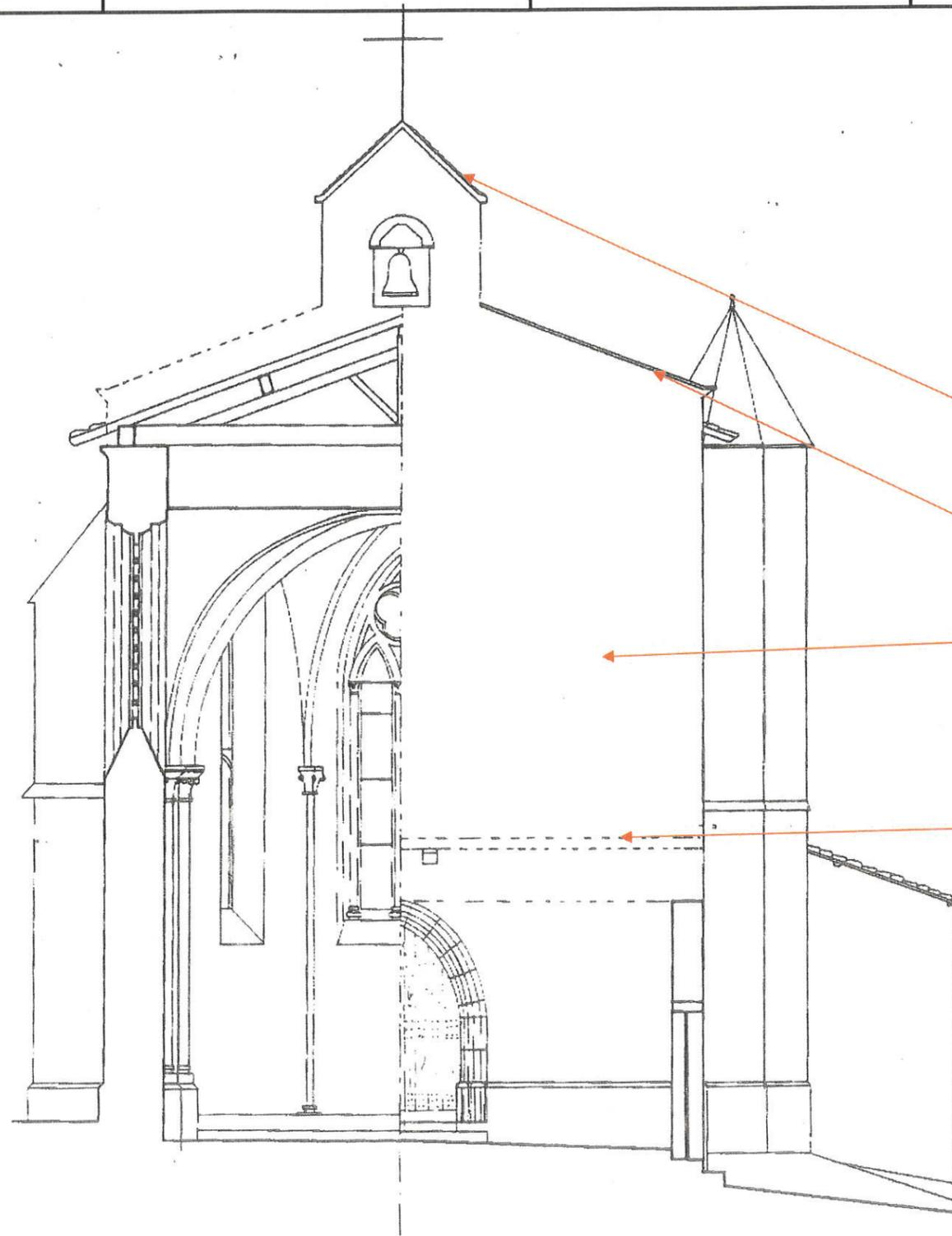
Réfection de la couverture en tuile en partie supérieure du mur clocher.
